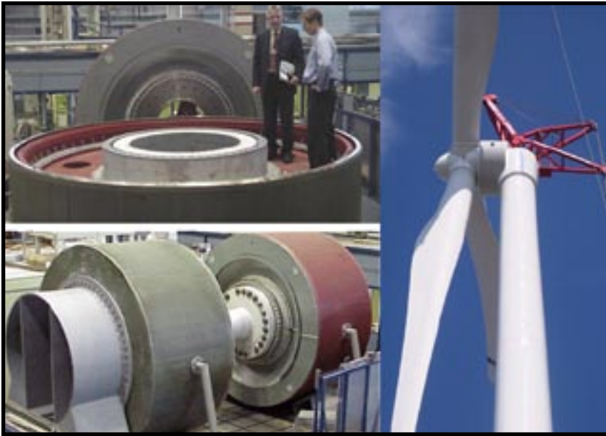
2. 1500 kWe 18,5 omw/min pm-generator ontwikkeld door ABB.
